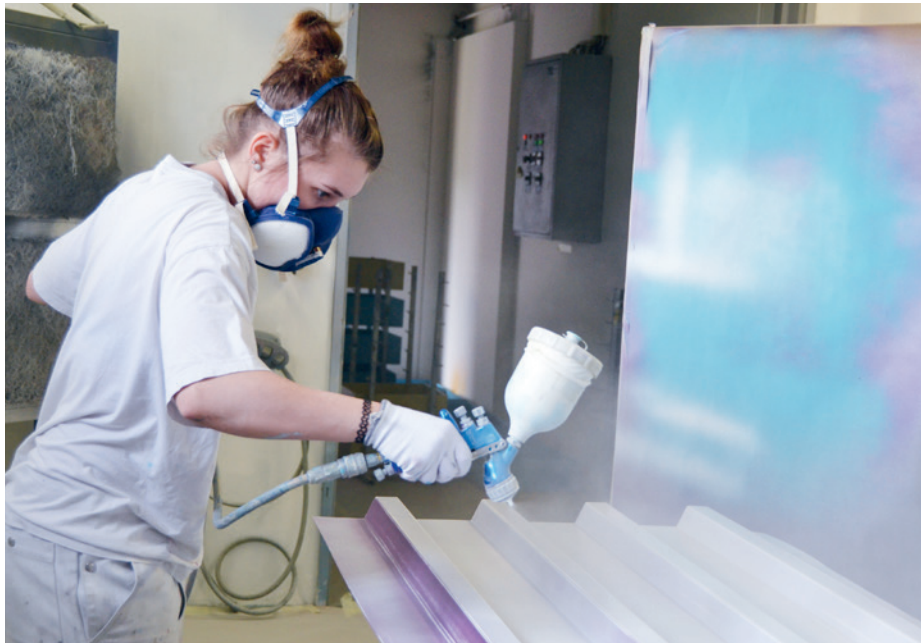
Spritzlackieren eines Wellblechs.
